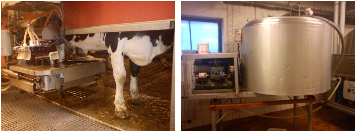
Figur 3-12: Mjölkrobot av fabrikatet Lely och en bufferttank från 70-talet.
